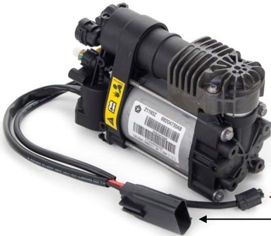
1. Attachez le connecteur d'alimentation du moteur en l'insérant dans la partie inférieure et en le verrouillant à l'aide du crochet triangulaire arrière.
